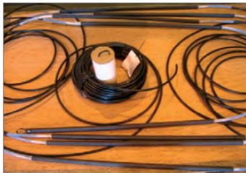
Gambar 4.2 Tubular MMO Anode
