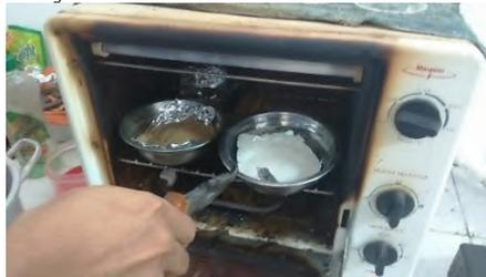
**Gambar 3.4** Proses pengeringan bahan uji menggunakan oven.
