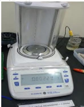
Gambar 4.7 Timbangan digital material biokomposit
