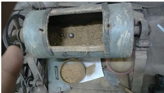
**Gambar 3.2** Mesin *Ball Mill* di Jurusan Teknik Sipil ITS
