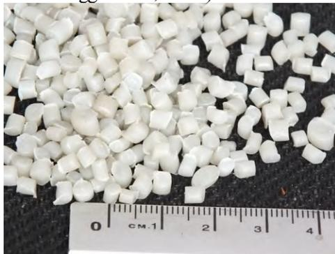
**Gambar 2.9** Salah satu contoh bentuk pellet dari material *polypropylene*
