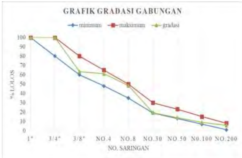
Gambar 4.15 Gradasi Campuran Aspal
