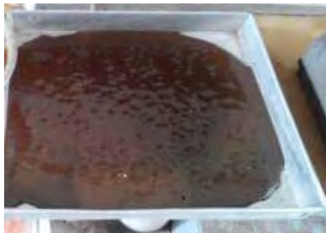
Gambar 4.7 Pasta Geopolimer untuk Menjadi Filler
