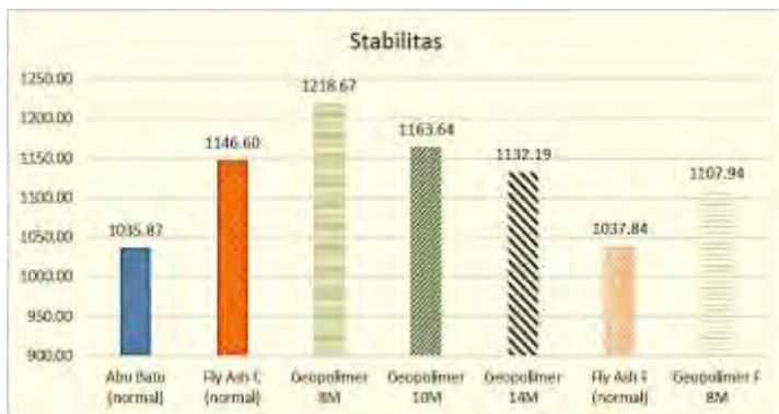
Gambar 4.32 Hubungan Stabilitas dengan Variasi Filler
