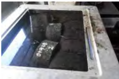
Gambar 4.22 Briket Direndam 30 menit Dalam Air Panas Sebelum Tes Marshall
