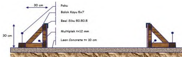
Gambar 5.9 Pemasangan bekisting pelat beton
