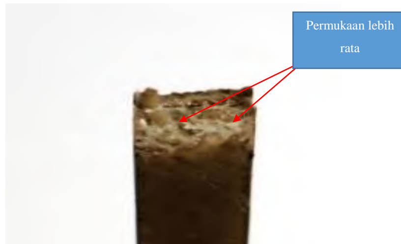
Gambar 4.40 Foto makro patahan uji bending komposisi 30%
