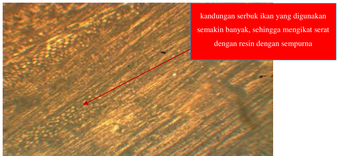
Gambar 4.38 Foto mikro serbuk tulang ikan tuna komposisi 60%
