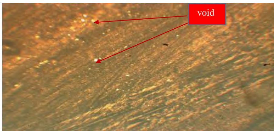
Gambar 4.36 Foto mikro tanpa serbuk tulang ikan tuna
