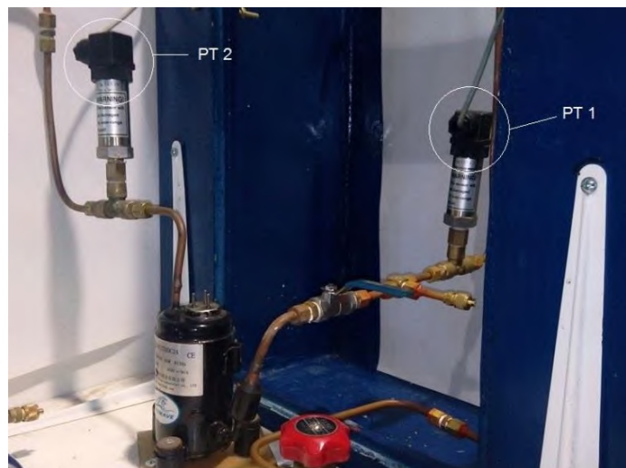
Gambar 3.17. Penempatan pressure transducer pada sistem pendingin
