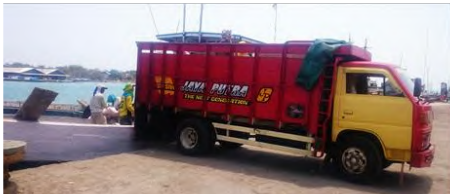
Gambar 4. 11 Truk engkel 9 Ton bongkar muatan ke kapal di pelabuhan sumenep
