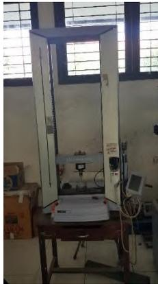
Gambar 3.6 Mesin Uji Tarik-Bending Shimadzu AG-X
