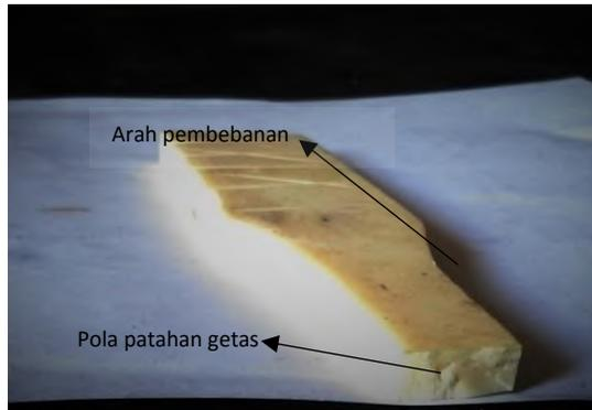
Gambar 4.10 Gambar permukaan pola patahan uji tarik polyester dengan penambahan 14% HGM pada temperatur *curing* 90° C.
