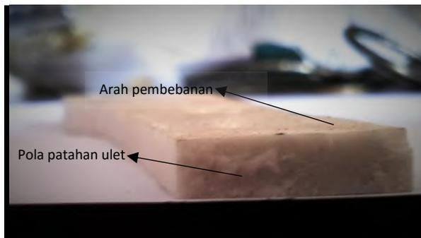
Gambar 4.8 Gambar permukaan pola patahan uji tarik polyester dengan penambahan 14% HGM pada temperatur *curing* kamar.
