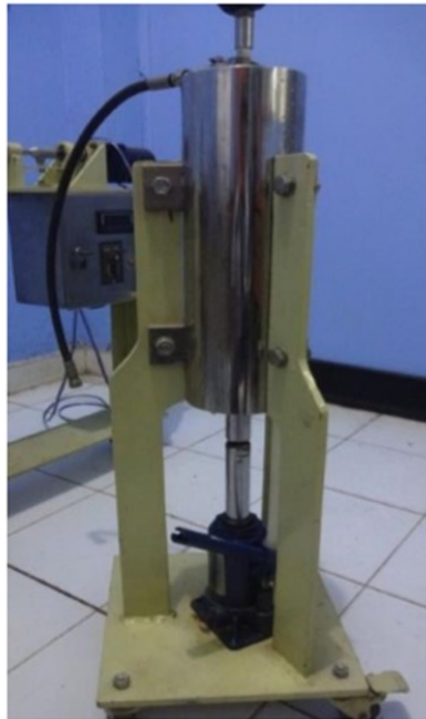
Gambar 2.10. Foto tabung tekanan air pada alat uji Geser Langsung Modifikasi (Hutagamissufardal, dkk, 2018)
