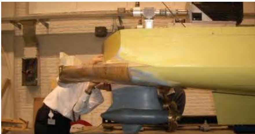
Gambar2.1 : Penambahan Ducktail pada buritan kapal. (DSME, 2008)
