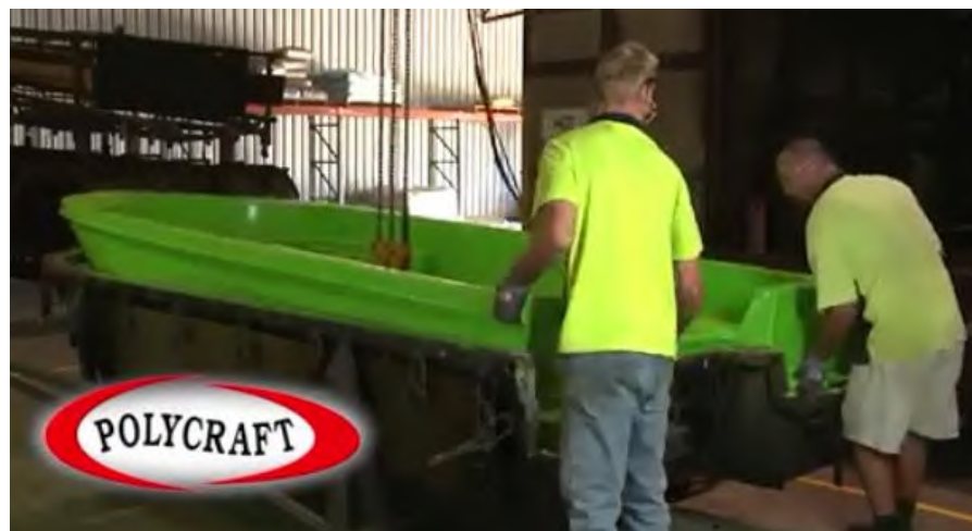
Gambar 2.14 Proses pelepasan kapal HDPE dari cetakan
