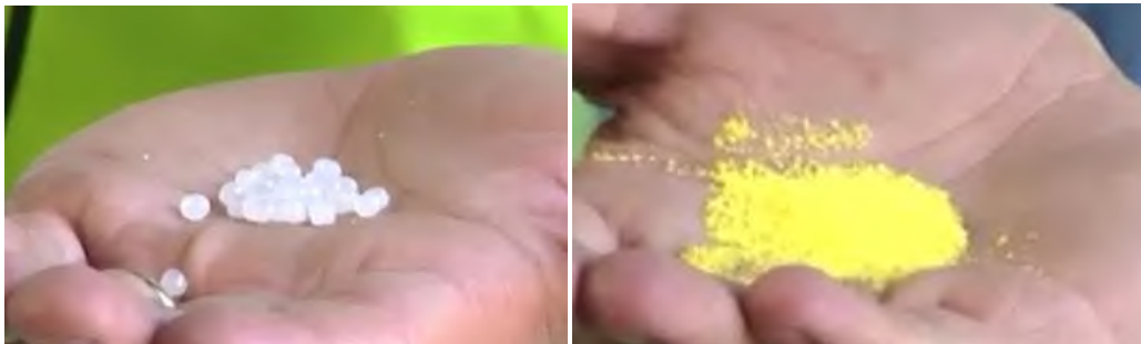
Gambar 2.10. Material plastik HDPE dalam bentuk pellets dan serbuk
