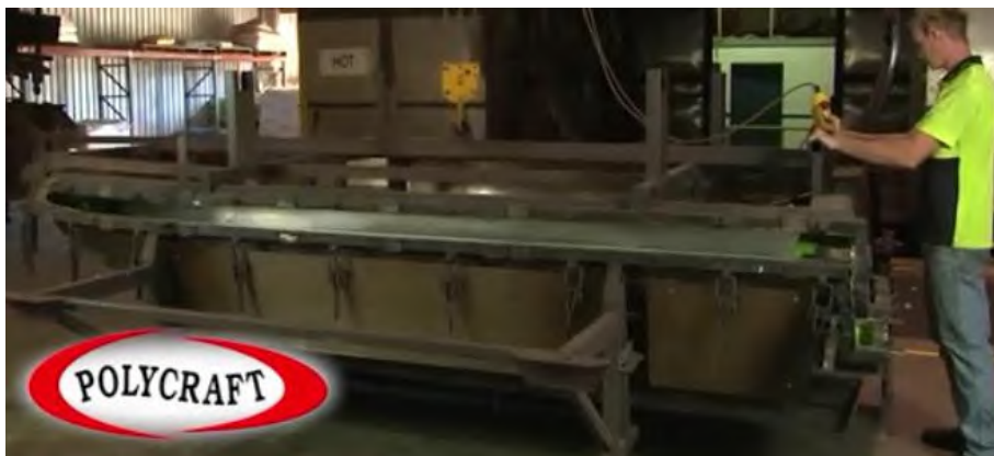
Gambar 2.12. Proses penutupan atau pemasangan cetakan bagian dalam
