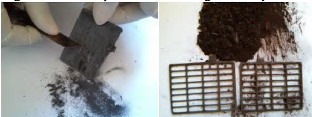
Gambar 3.23. Proses pengambilan serbuk pada elektroda.
