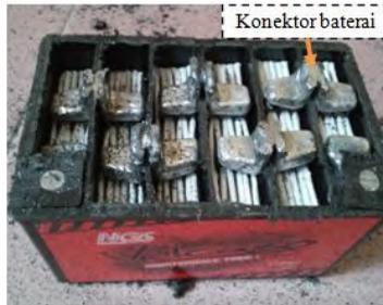
Gambar 3.18. Pemotongan konektor baterai.
