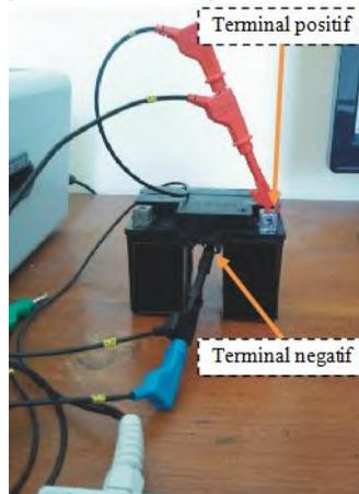
Gambar 3.10. Penyambungan kabel untuk pengujian Autolab.
