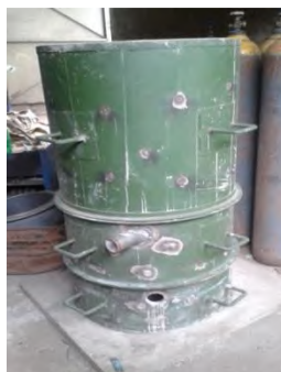
Gambar 3.2 Reaktor gasifikasi downdraft
