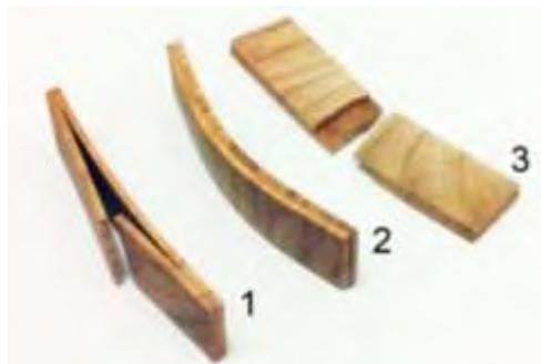
*Gambar 4.18. Hasil bending eksperimen 3.1
