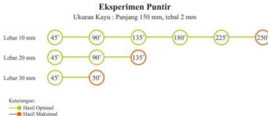
Gambar 4. 38. Perbandingan Hasil Puntir Panjang 150 mm dan Tebal 2 mm
