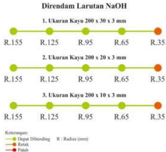
*Gambar 4. 28. Perbandingan Hasil Bending Direndam Larutan NaOH
