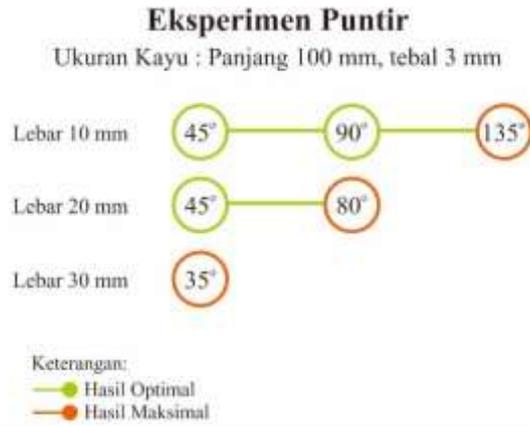
Gambar 4. 34. Perbandingan Hasil Puntir Panjang 100 mm dan Tebal 3 mm
