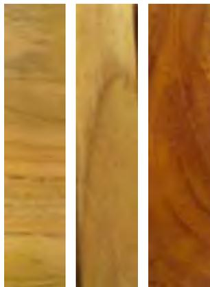
Gambar 4. 9. Arah serat horizontal (kiri), vertikal (tengah), dan melintang
