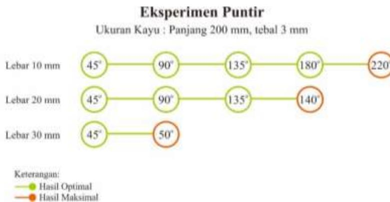
Gambar 4. 30. Perbandingan hasil puntir panjang 200 mm dan tebal 3 mm
