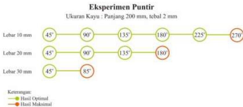
Gambar 4. 36. Perbandingan Hasil Puntir Panjang 200 mm dan Tebal 2 mm
