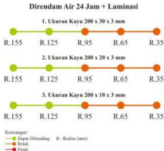
**Gambar 4. 25. Perbandingan Hasil Bending Direndam Air 24 Jam + Laminasi**
