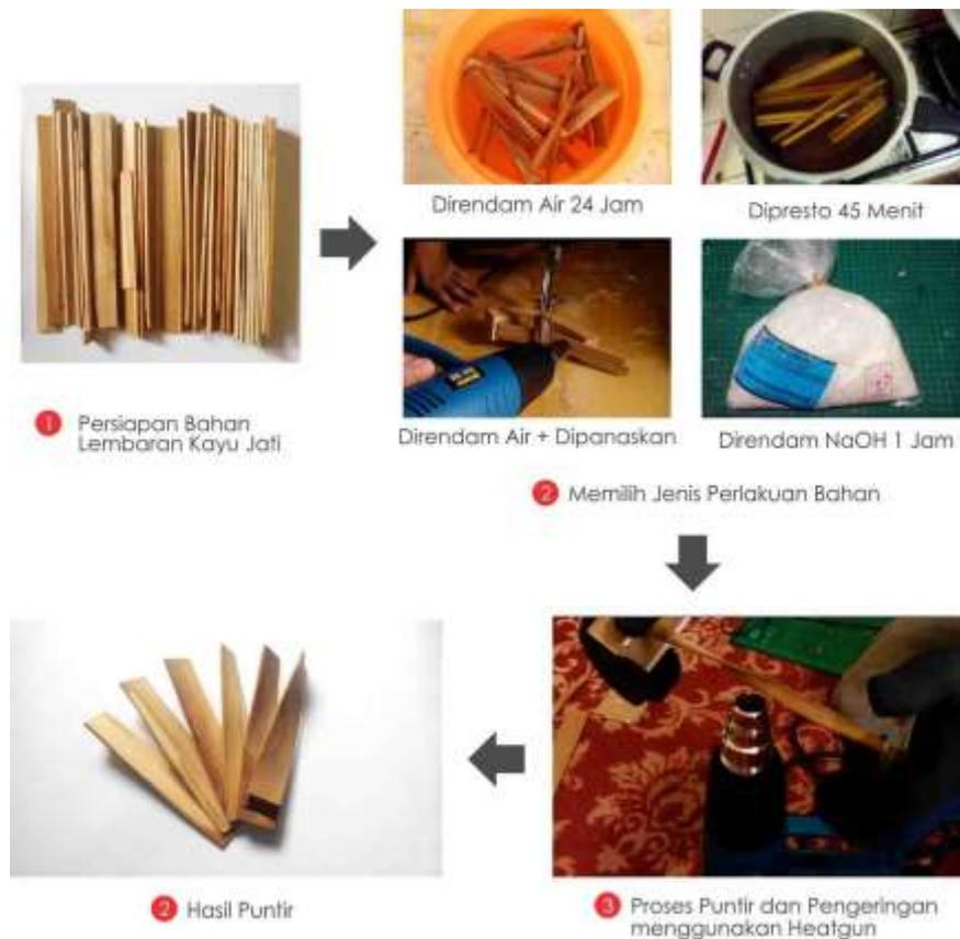
Gambar 4. 29. Diagram proses pengolahan material untuk eksperimen puntir
