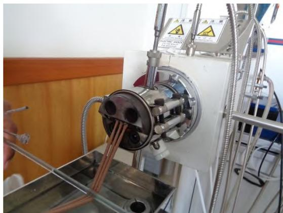
Gambar 3.14 Proses Ekstrusi
