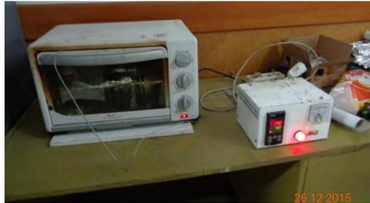
Gambar 3.6 *Oven* dilengkapi *Temperature Control*
