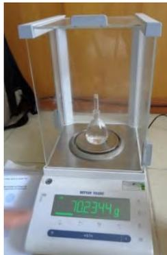
Gambar 3.15 Pengukuran Densitas
