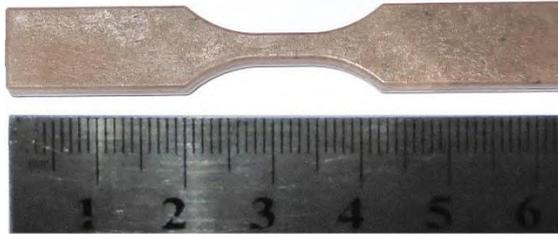
Gambar 4.4 Spesimen Pengujian Tarik ASTM D 638-03 tipe V
