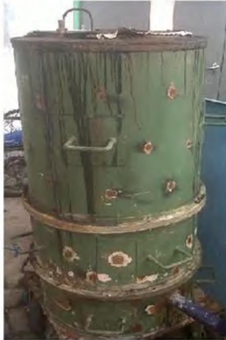
Gambar 3.2 Unit utama reaktor gasifikasi *downdraft*.
