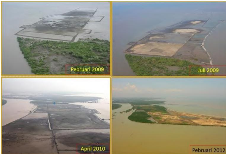
**Gambar 4.9** Proses Perluasan Pulau Lumpur *Spoil Bank* Secara *Time Series*
