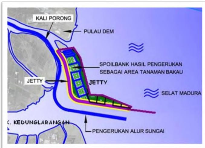
**Gambar 4.12** Penanganan Endapan Sedimen di Muara Sungai Porong dari Tahun 2011 Hingga Saat Ini
