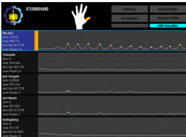
Gambar 5.3 Hasil uji ketika jempol digerakkan
