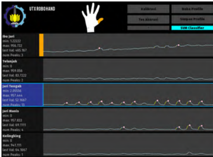
Gambar 5.9 Hasil uji ketika jari tengah digerakkan
