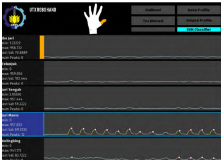
Gambar 5.12 Hasil uji ketika jari manis digerakkan
