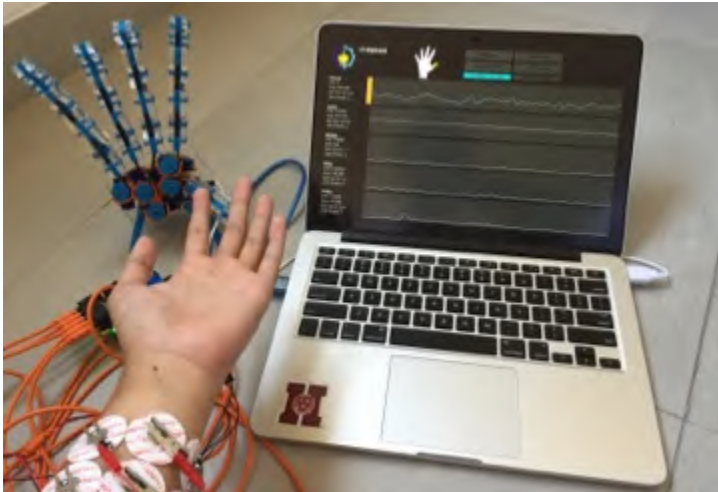
Gambar 5.7 Posisi awal gelombang EMG pada jari tengah (grafik ketiga dari atas) terlihat stabil.
