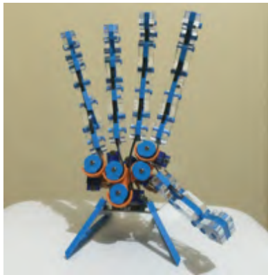
Gambar 4.1 Tampak depan implementasi prosthetic hand
