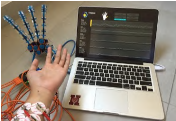
Gambar 5.10 Posisi awal gelombang EMG pada jari manis (grafik kedua dari bawah) terlihat stabil.
