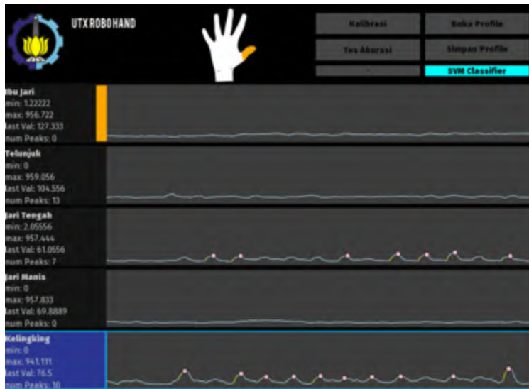
Gambar 5.15 Hasil uji ketika jari kelingking digerakkan
