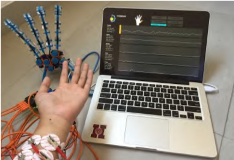
Gambar 5.20 Posisi awal gelombang EMG pada jari tengah (grafik ketiga dari atas) terlihat stabil.
