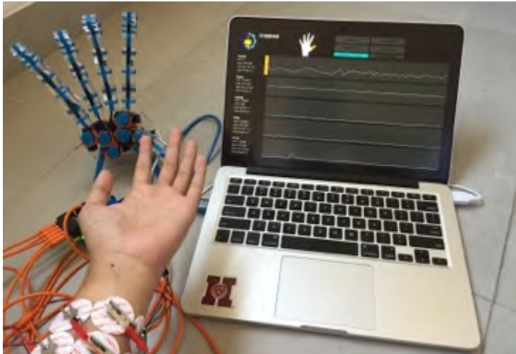
Gambar 5.13 Posisi awal gelombang EMG pada jari kelingking (grafik paling bawah) terlihat stabil.
