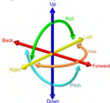
Gambar 2.2 DoF sebuah benda dalam ruang 3-dimensi
