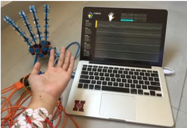
Gambar 5.22 Posisi awal gelombang EMG pada jari manis (grafik kedua dari bawah) terlihat stabil.
