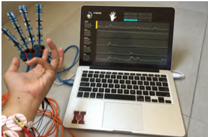
Gambar 5.14 Saat jari kelingking digerakkan, terjadi fluktuasi pada gelombang EMG jari kelingking (grafik paling bawah) dan terdeteksi bahwa terjadi gerakan (terdapat point (titik) merah pada puncak grafik).
