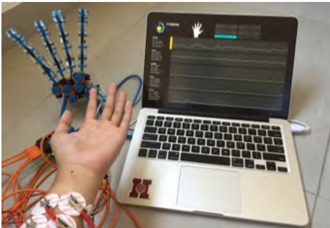
Gambar 5.24 Posisi awal gelombang EMG pada jari kelingking (grafik paling bawah) terlihat stabil.
