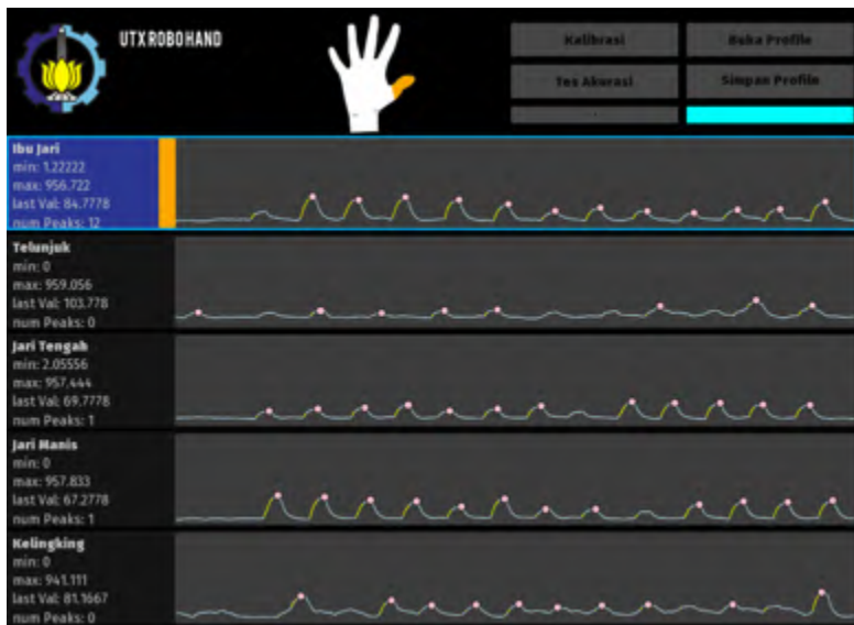
Gambar 5.26 Hasil uji ketika kelima jari digerakkan
