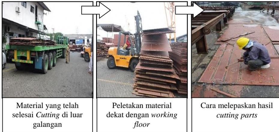
Gambar 4.6. Proses penanganan material yang di *cutting* sub-kontraktor.
