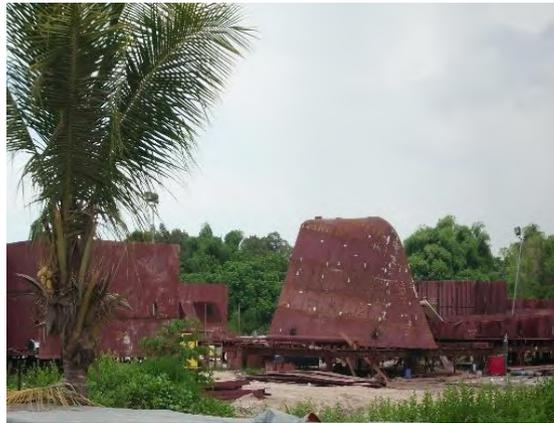
Gambar 4.18. Blok-blok kapal perintis yang telah selesai di *assembly*
