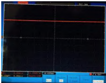
Gambar 3.19 Sinyal Tp 4 ( Setingan comparator ) IC LM 393
