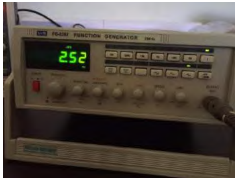
Gambar 3.9 Inputan frekuensi sebesar 2.52 pada function generator
