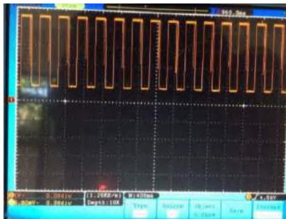
Gambar 3.12 Sinyal Tp 3 dengan frekuensi 2,52 Hz
