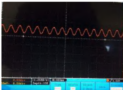
Gambar 3.10 Sinyal Tp 1 dengan frekuensi 2,52 Hz
