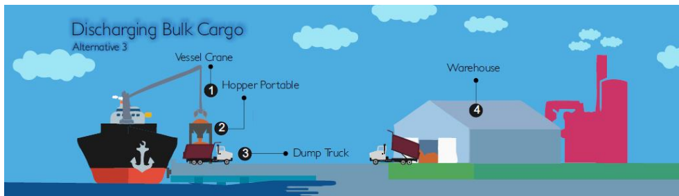
Gambar 1.5 Pembongkaran menggunakan Vessel Crane
