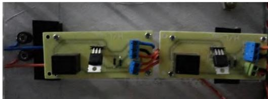
**Gambar 3.6** Rangkaian elektrik sensor *Float Switch*
