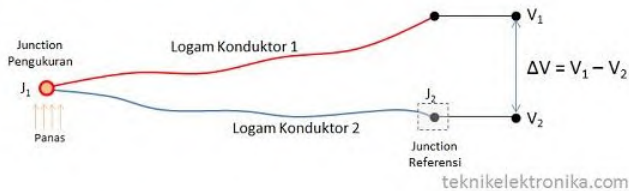
Gambar 2.8 Konstruksi Termokopel ( thermocouple )
