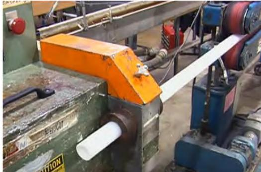
Gambar 2.8. Proses Ekstrusi
