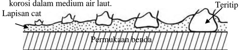
**Gambar 2.16** Teritip menghancurkan lapisan cat antikorosi (Railkin *et al.*, 2005)
