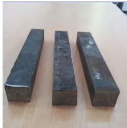
Gambar 3.12. Benda kerja baja EMS 45
