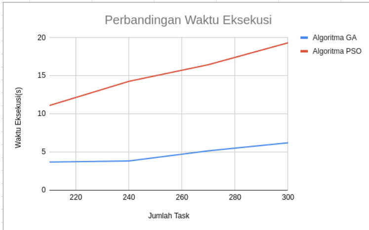
Gambar 5.5: Grafik Perbandingan Waktu Eksekusi dengan Jumlah Task
