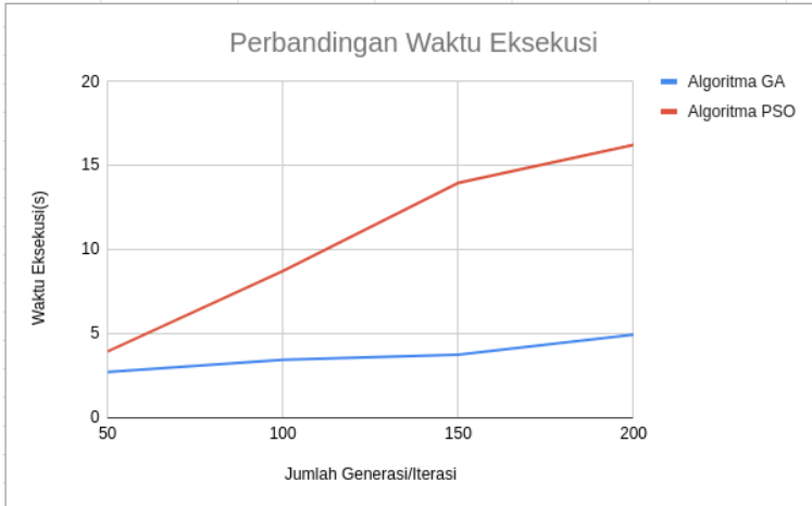
Gambar 5.9: Perbandingan Waktu Eksekusi dengan Maksimal Generasi/Iterasi
