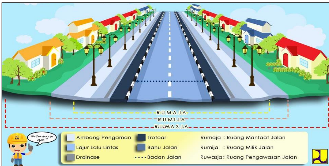
Gambar 2.1 Bagian-Bagian Jalan (UU 38/04 Tentang Jalan)
