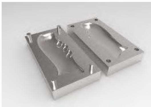
Gambar 4. 48 cetakan baja untuk desain pisau
