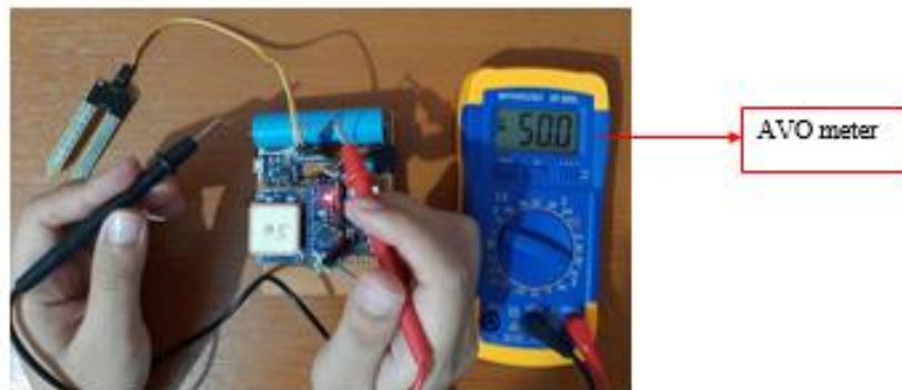
Gambar 4.16 Pengujian Arus Menggunakan AVO Meter Digital
