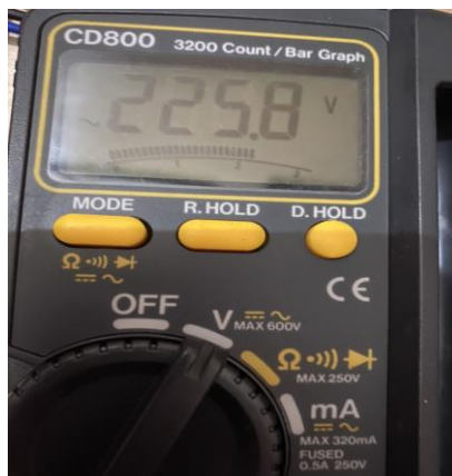
Gambar 5.18 Avo Meter Mengukur Tegangan
