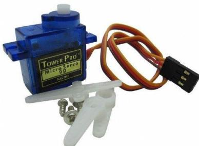
Gambar 2.3 Motor Servo SG90.
