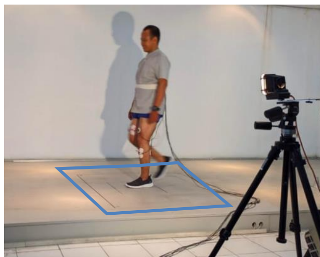
Gambar 3.6 Force Plate yang ditanam pada lintasan berjalan
