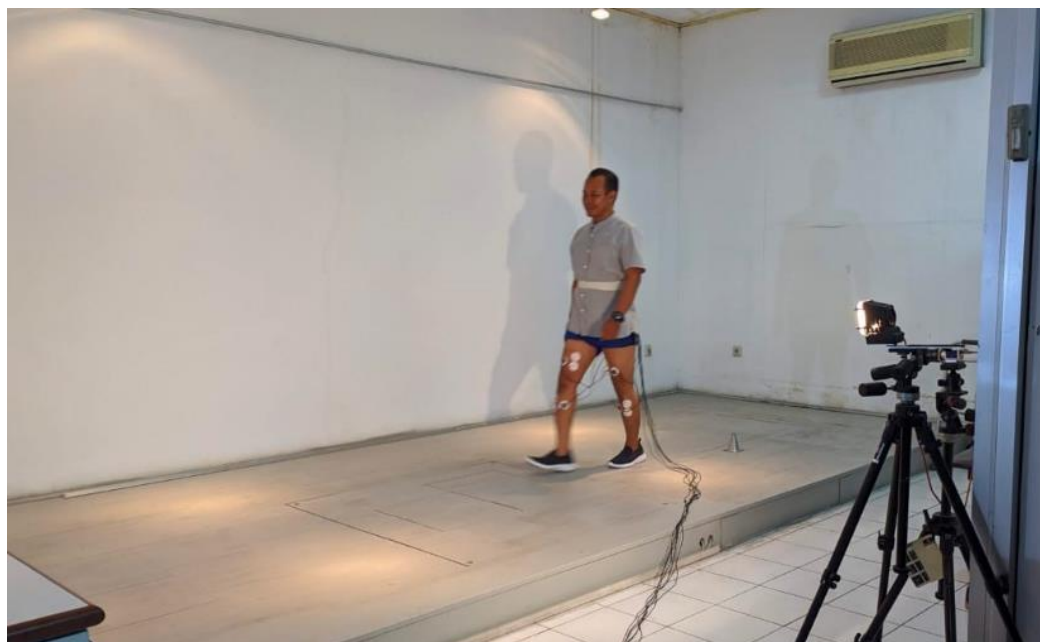
Gambar 3.11 Proses Pengambilan Data EMG dan GRF
