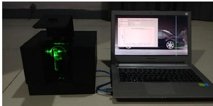
Gambar 3.2 Peralatan yang dikembangkan untuk melakukan pengambilan data spektrum Raman
