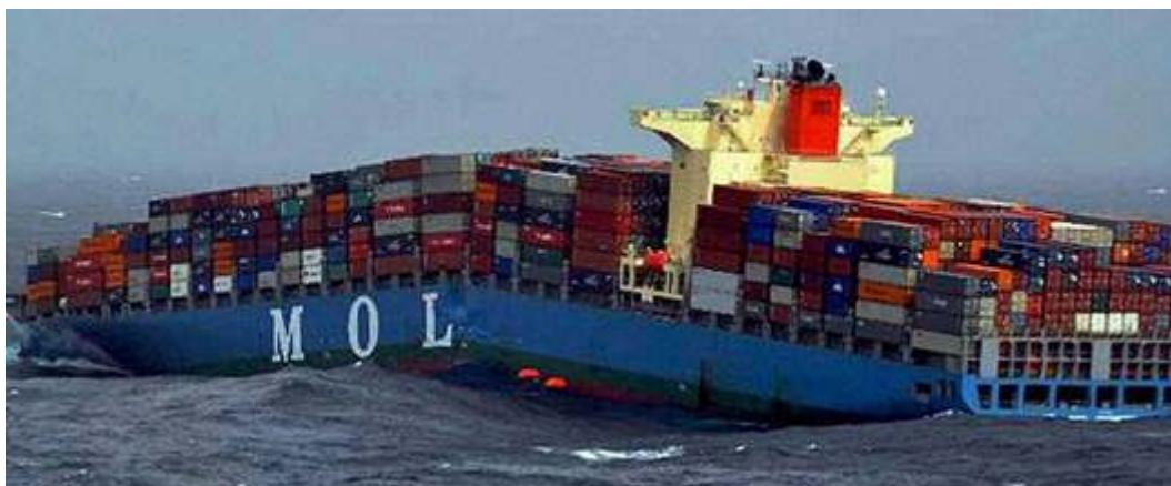
Gambar 1. 2 : *Crack* pada kapal akibat fatigue
