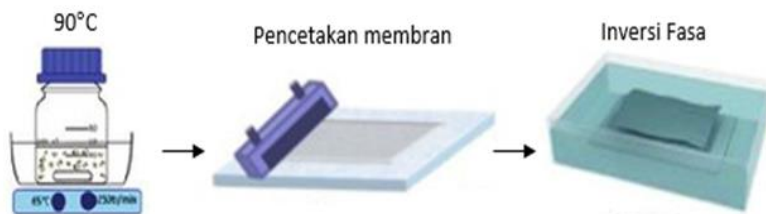
Gambar 3.3 Skema preparasi membran
