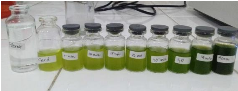
Gambar 4.14 Perubahan warna retentat mikroalga selama 40 menit pertama membran PVDF/LiCl 2%
