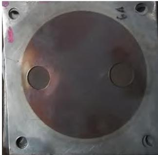
*Gambar 4.20 Elektroda SS 316 Tipe Dry Cell dengan Penambahan PWM Setelah Pengujian Mencapai Temperatur =  $70^{\circ}\text{C}$*
