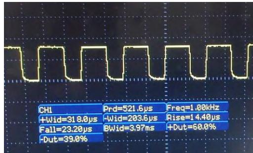
*Gambar 4.17 Grafik Duty cycle 60 % dan Frekuensi 1 kHz pada Osiloskop*
