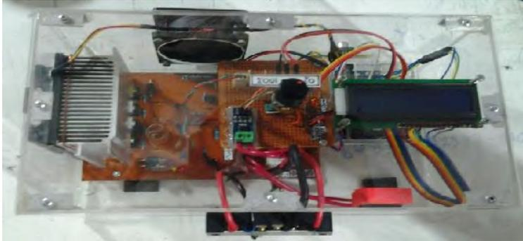
*Gambar 3.15 Rangkaian Elektronika PWM*
