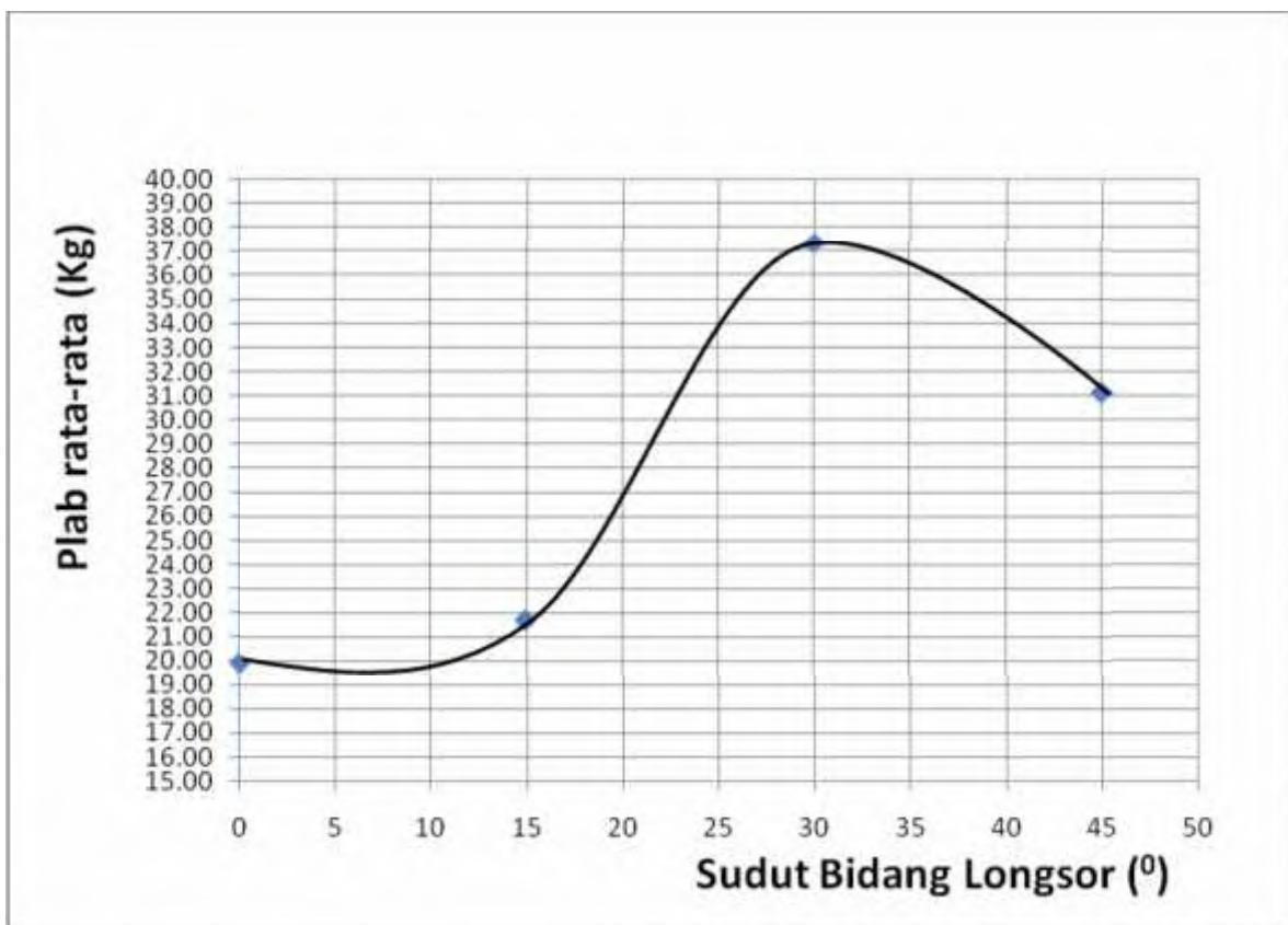
Gambar 4.13 Hubungan Plab rata-rata dan Posisi Tancap Cerucuk pada Sudut Bidang Longsor
