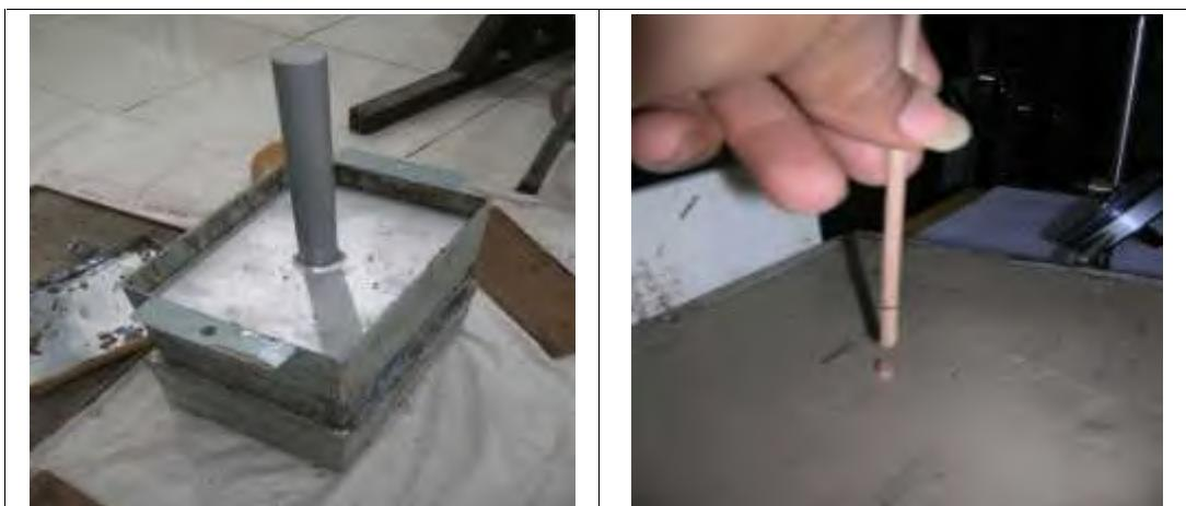
Gambar 4.8 Kegiatan persiapan benda uji sebelum pengujian geser langsung
