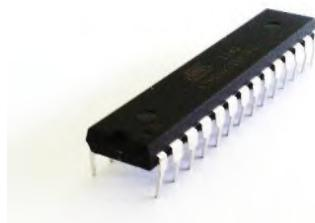
**Gambar 2.14.** Mikroprosesor ATMega 328<sup>[4]</sup>
