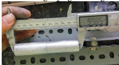
Gambar 3.12 Pengukuran *Adherend* Tanpa *Adhesive*
