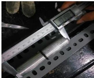
Gambar 3.14 Penyambungan *Adherend* dengan *Adhesive*
