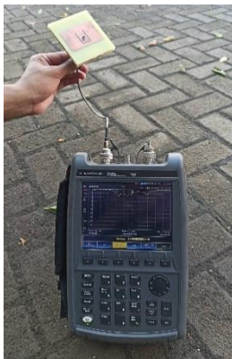
Gambar 4.35 Diagram Pengukuran dan Pengukuran VSWR dan Return Loss Menggunakan Network Analyzer
