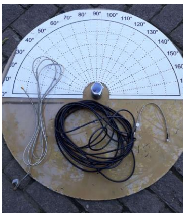
Gambar 4.39 Busur Acuan Pengukuran Pola Radiasi dan Kabel yang Digunakan
