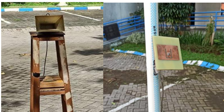
Gambar 4.40 Penyangga Non Metal untuk Menyangga Antena Referensi dan Antena Uji
