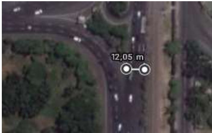
Gambar 4. 1 Pengukuran geometri lebar pendekat bagian jalan
