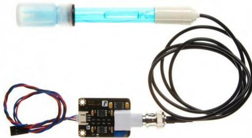
**Gambar 3.7** Sensor pH DFrobot
