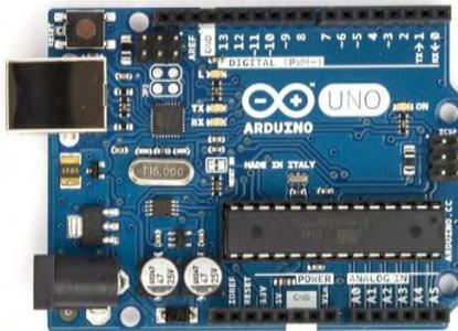
**Gambar 2.7** Arduino Uno R3<sup>[9]</sup>
