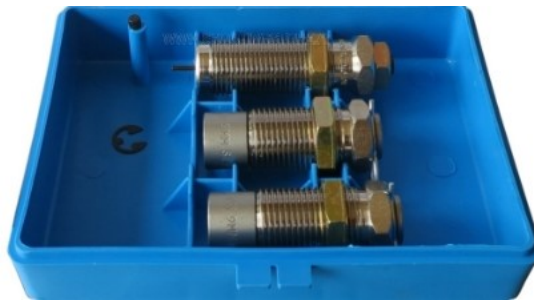
Gambar 4. 13 Perkakas Hartmetall untuk Proses Susun Munisi
