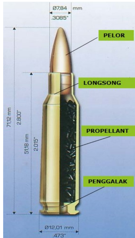
Gambar 2. 1 Komponen pada Munisi (sumber : PT. Pindad)
