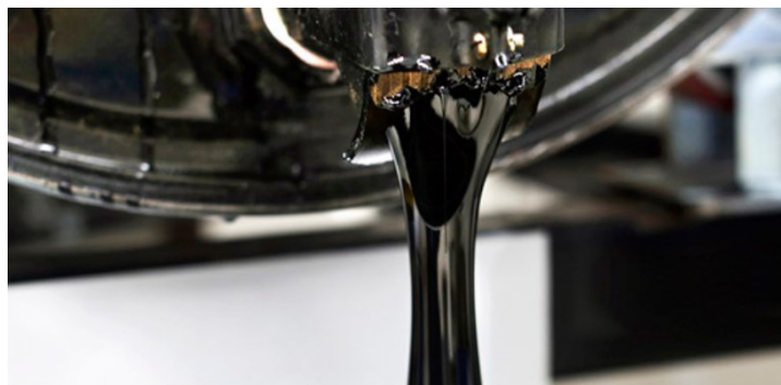
Gambar 4. 12 Vernis Bituminlak untuk Mulut Longsong
