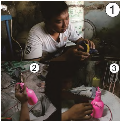
Gambar 4.6 Berturut-turut dari nomor 1 hingga 3 adalah proses pembuatan lampu hias mulai dari pengamplasan, penempelan stiker dan pengecatan dan pelepasan stiker
