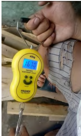
Gambar 4.3 Percobaan untuk mendapatkan gaya untuk memindahkan mata potong
