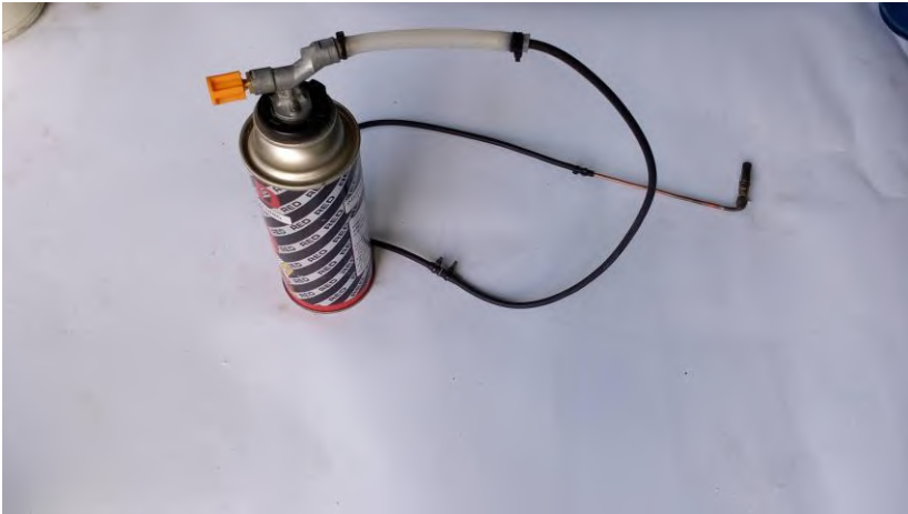
Gambar 2.14 Pemanas yang digunakan dalam mesin pemotong botol
