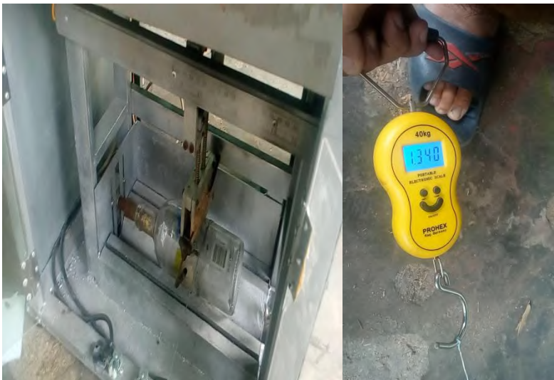
Gambar 4.2 Percobaan untuk mendapatkan gaya untuk memutar motor yang sudah dibebani botol kaca
