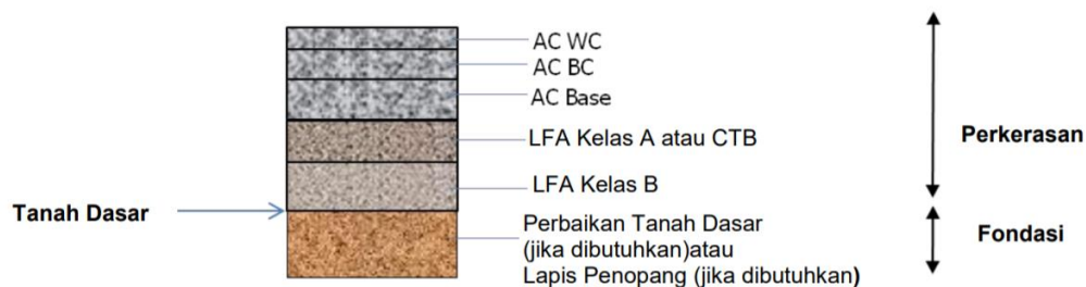
Gambar 2.3 Tipikal Struktur Perkerasan Lentur pada Galian (Kementerian Pekerjaan Umum dan Perumahan Rakyat, 2017)
