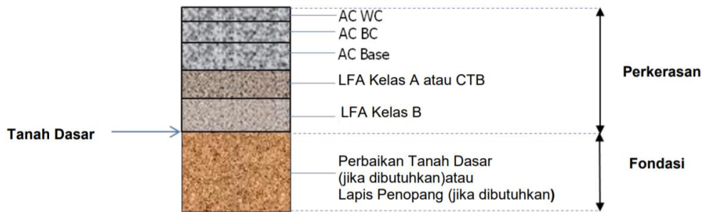
Gambar 2.1 Tipikal Struktur Perkerasan Lentur pada Permukaan Tanah Asli (Kementerian Pekerjaan Umum dan Perumahan Rakyat, 2017)
