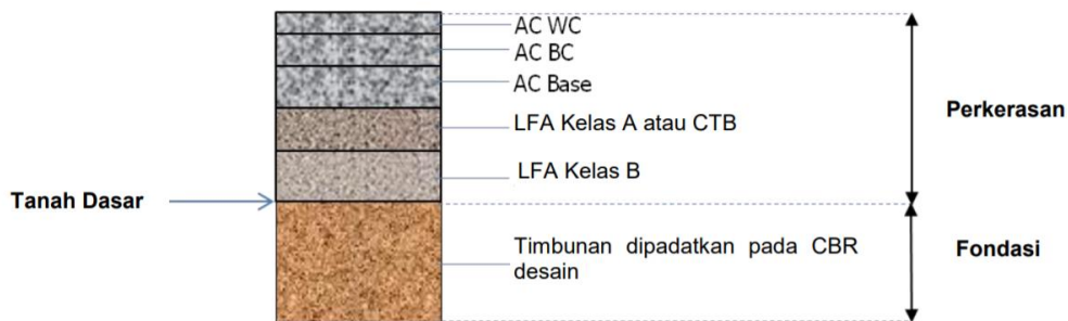
Gambar 2.2 Tipikal Struktur Perkerasan Lentur pada Timbunan (Kementerian Pekerjaan Umum dan Perumahan Rakyat, 2017)
