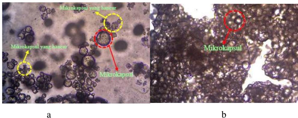
Gambar 2. 26 Pengamatan mikroskop optik morfologi mikrokapsul dengan variasi temperatur 40° C dan 50°C (Hanurogo, 2019)
