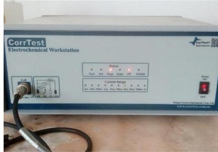
Gambar 3. 9 Alat Uji Polarisasi Potensiodinamik
