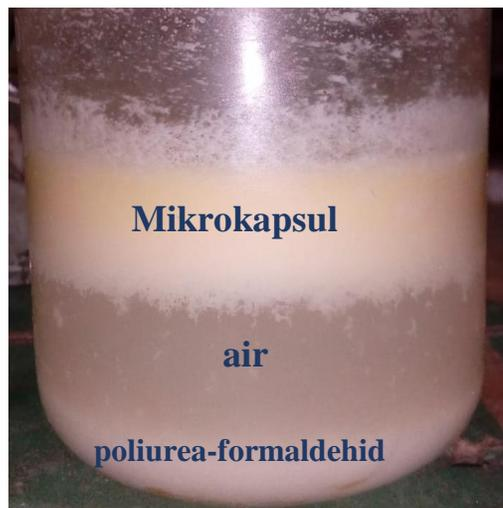
Gambar 4. 1 Suspensi yang terbentuk setelah proses pengadukan
