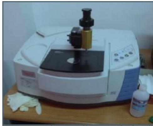
Gambar 3. 7 Alat uji FTIR
