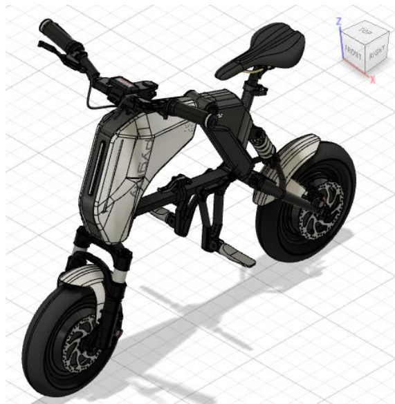
Gambar 3. 4 Desain e-bike pada software Autodesk Fusion 360
