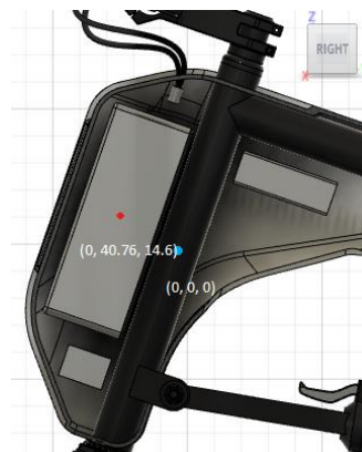
Gambar 4. 6 Titik beban battery pada kondisi statik
