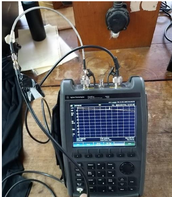
Gambar 3.4 Pengukuran loss kabel
