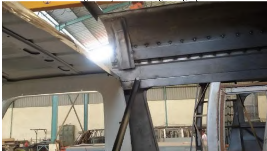
Gambar 4 . 21 Pemasangan besi profil untuk rangka dengan pelat bodi kendaraan
