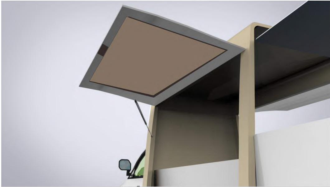
Gambar 4 . 35 ilustrasi pemasangan panel interior ke rangka pintue
