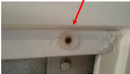
Gambar 4 . 33 contoh pemasanganudukan untuk klip pengunci ke rangka interior.
