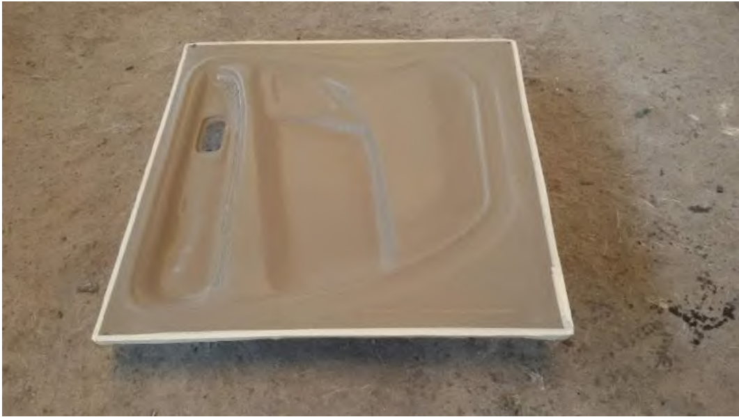
Gambar 4 . 32 material fiberglass untuk panel penutup pintu (sumber;dokumentasi pribadi )
