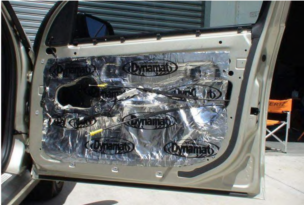
Gambar 4 . 16 pemasangan peredam pada panel pintu kendaraan. Sumber ( http://news.okezone.com/read/2015/04/15/15/1134842/mengapa-peredam-bisa-tingkatkan-kualitas-audio-mobi )
