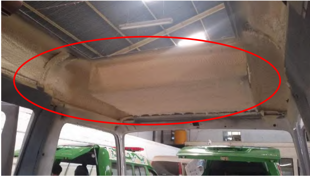
Gambar 4 . 18 aplikasi peredam polyurethane cair untuk bagian atap kendaraan (sumber:dokumentasi pribadi)
