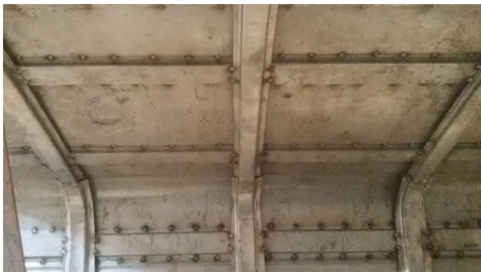
Gambar 4 . 22 pemasangan rangka dan pelat galvanis dengan rangka utama kendaraan, pemasangan memakai metode las oksigen ( CO spot welding)
