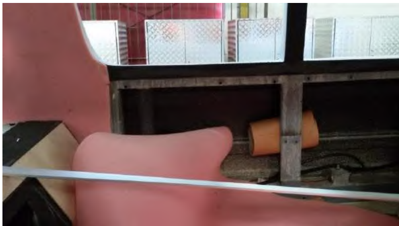
Gambar 4 . 17 bahan foam untuk peredam panas dan getaran kabin ( sumber; dokumentasi pribadi)
