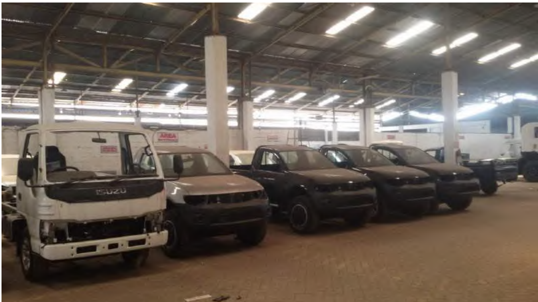
Gambar 4 . 28 Kendaraan yang selesai stripped off menunggu untuk mulai proses body welding
